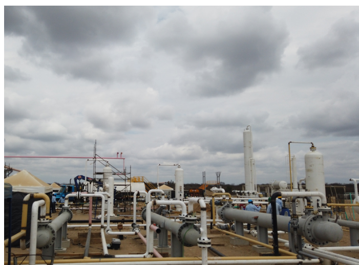
Sistema de ajuste Dew Point CPF Maria Conchita - Quadranti 2021
